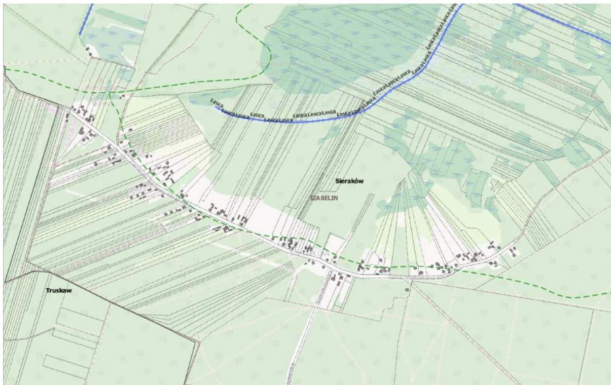
Rycina 106. Infrastruktura systemu odwodnienia dróg na terenie sołectwa Sieraków
