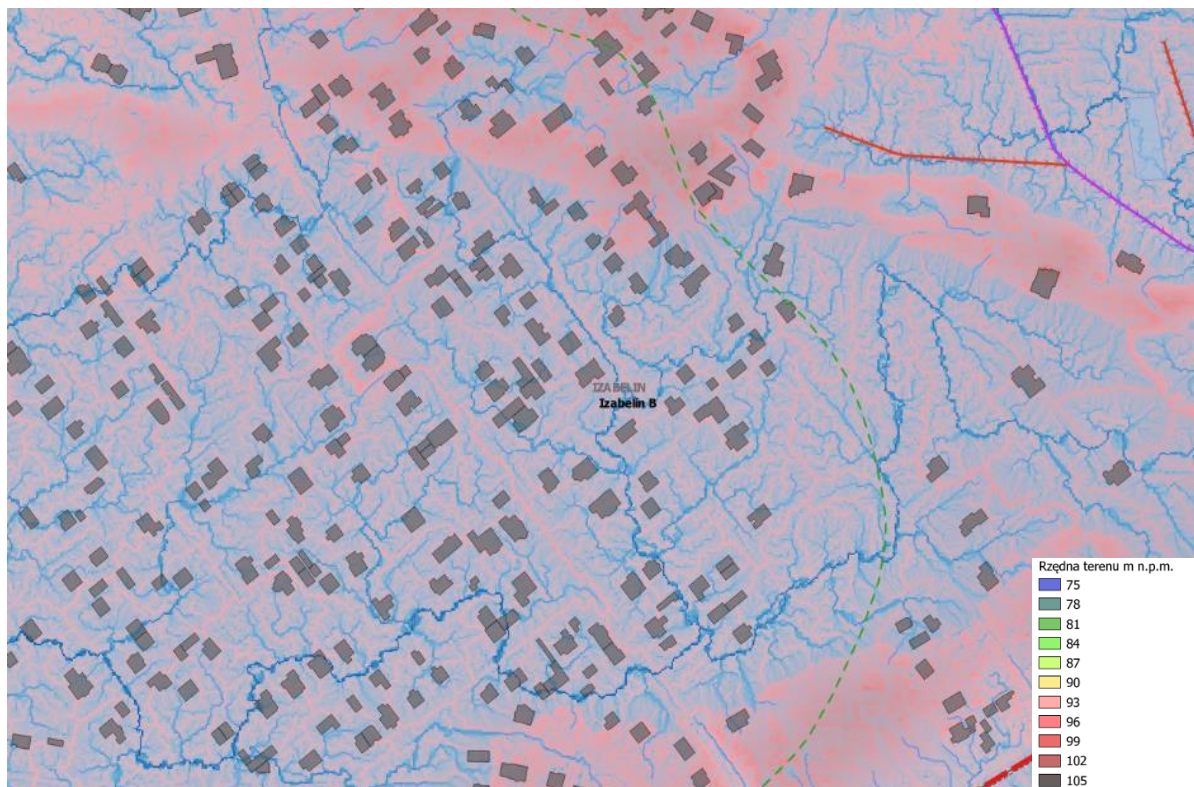
Rycina 23. Wygenerowane linie spływów w obszarze zlewni „Izabelin B” Linie niebieskie oznaczają spływ powierzchniowe (kierunki i intensywność)
